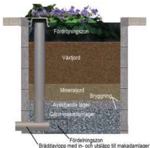
Figur 11. Exempel på uppbyggnad av regnbädd med tjockt lager växtjord för att möjliggöra plantering av träd. Vid hög vattenbelastning bräddas vatten ut i kupolbrunn (Movium 2015).
