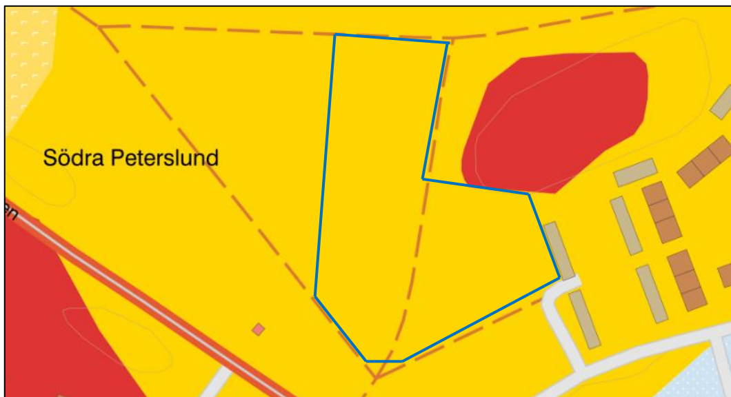
Figur 3. SGUs jordartskarta över aktuellt undersökningsområde. Gul färg markerar glacial lera; röd färg markerar berg i dagen. Blå figur markerar områdets ungefärliga avgränsning.
